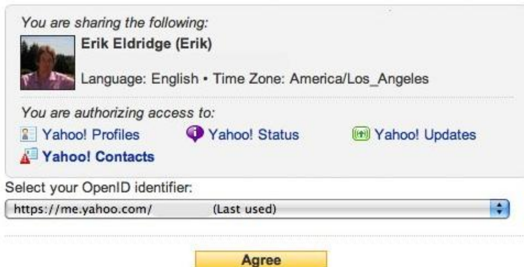
Ilustración 5. Ejemplo de interfaz integrada de autenticación (con OpenID) y autorización (con OAuth).
